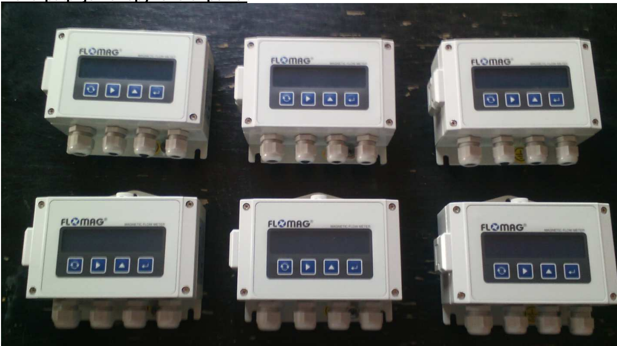
Нови конвертори сигнала за ПППВ, Резервоар Опленац, Прекидну комору...
