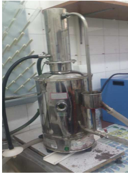
Дотрајали дестилатор у лабораторији на ПППВ
